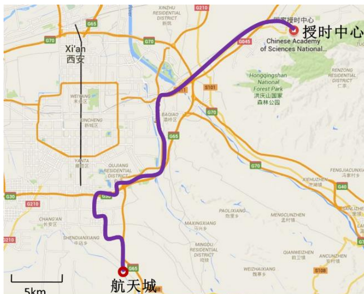
图2 112 km 实地光纤示意图
