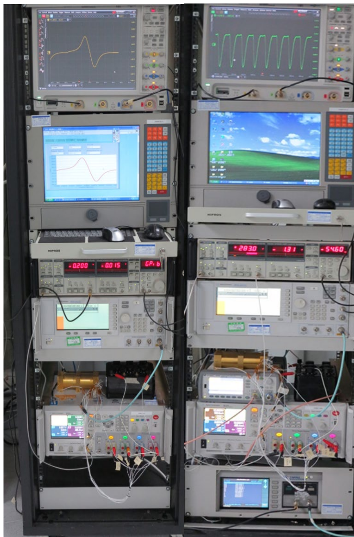
图 2 铷原子钟钟跃迁谱线测量及闭环实物图
