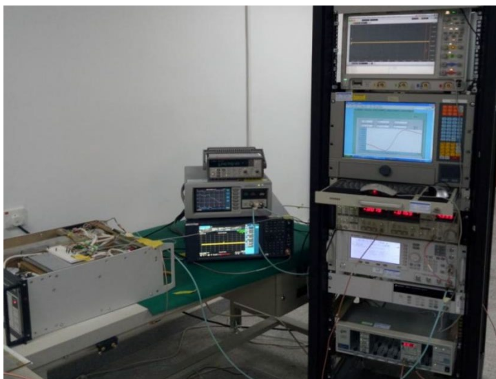
图 5 被动型氢原子钟原子鉴频曲线测试实物图
