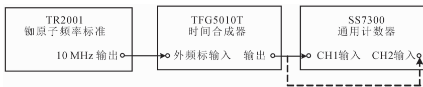
图 3 时间间隔测量误差检定系统框图
