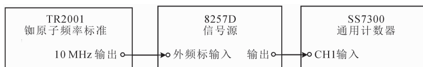
图 2 频率测量误差检定系统框图
