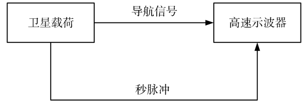
图 5 时域测量方法原理框图
