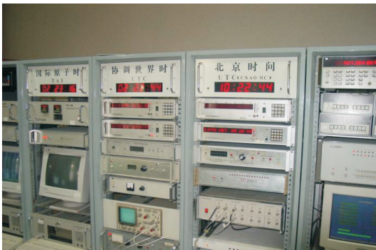
图 4 20 世纪 90 年代的守时装置(1999 年 10 月)
