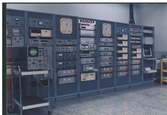
图 2 20 世纪 80 年代的国家标准时间产生系统
