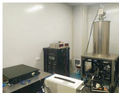
图 5 铷原子喷泉钟 NTSC-RbF1
