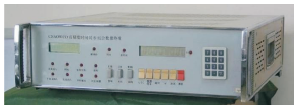
图 1 卫星双向话音通道高精密时间同步系统设备
