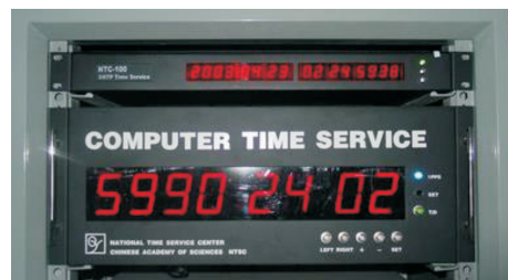
图 2 NTC-100 型 SNTP 网络时间服务器
