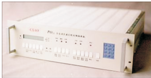
图 4 PO21 型全自动长波定时校频接收机
