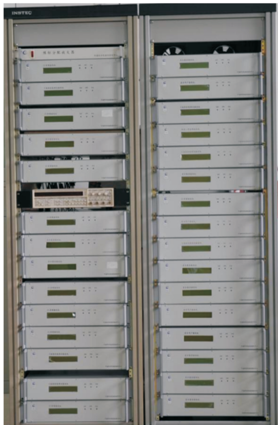
图 14 转发式卫星导航试验系统 PVT 接收机
